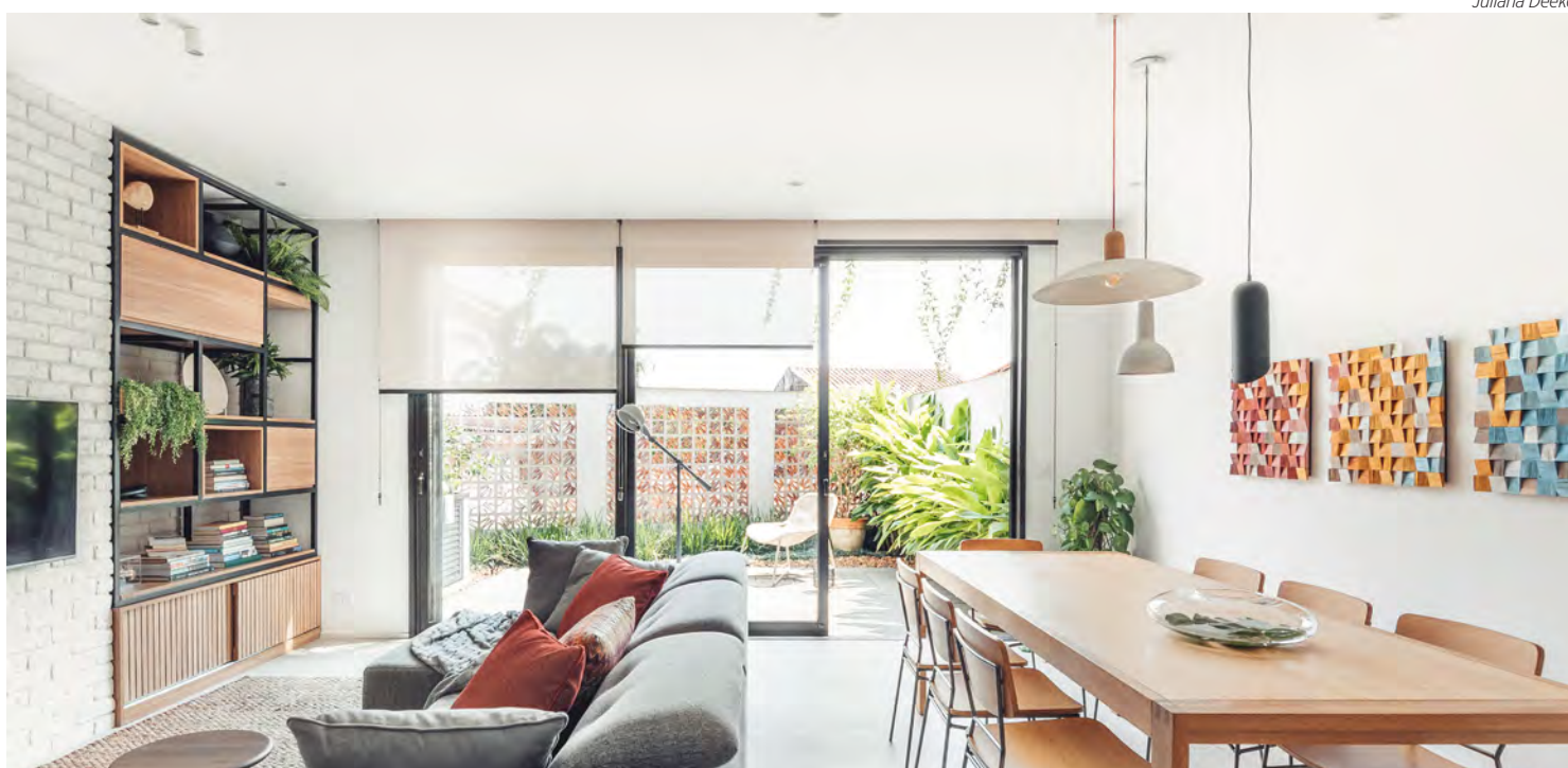
No projeto Casa Alegre, a inclusão de cobogós no muro de divisa (foto 1) com o terreno ao lado auxiliou a entrada de ar fresco para o quintal e, conseqüentemente, para dentro da casa. Além disso, o ar que passa pelo caixilho, encontra o átrio no lado oposto da área social (foto 2), promovendo a troca de ar
