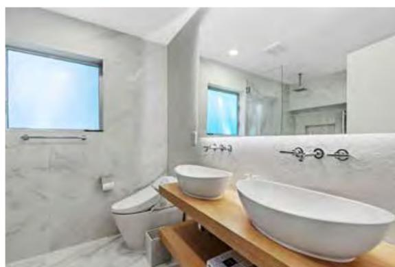
metro de largura, por exemplo, que vai guardar grande peso, dependerá de três pontos de fixação na estrutura, um a cada 40 cm, sendo um no meio e os outros dois nas extremidades.
