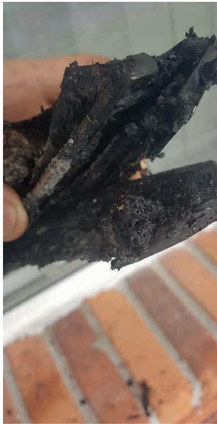
Celular explode devido a problemas na bateria
